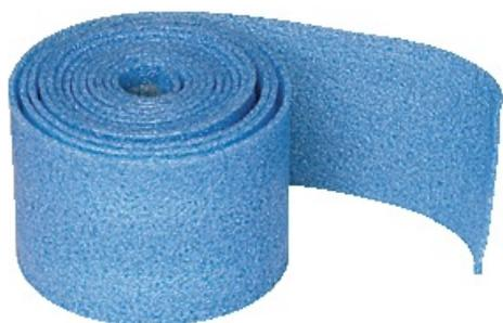
Bande en mousse de polyéthylène extrudé de 5 mm destinée à désolidariser les chapes flottantes, mortier de scellement, chapes sèches des parois verticales, des pieds d'hubriserie, seuils et de toute émergence (fourreaux de canalisations, poteaux, murets...).
