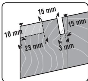
4. Prévoyez une fente de 3x15mm sur toute la longueur de la poutre de gouttière en bois. Pour des applications avec du double vitrage, il faut prévoir un fraisage de 10 x 23 mm sur toute la longueur.
