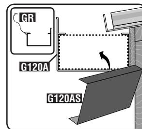
7. Installez la gouttière en alu G120A contre la planche de gouttière et étanchez les obturateurs avec du silicone. Si vous utilisez la pièce de réhausse de gouttière, il faut la visser tous les 50 cm et positionner la face la plus haute contre la poutre de gouttière en bois.
