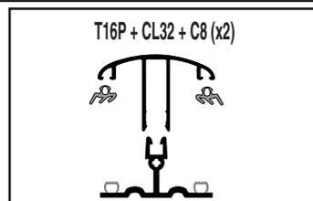
8. Pour des applications avec des plaques de 25 /32 mm, il faut utiliser les clips CL32 (voir à la page 10).
