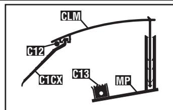
8. Clipsez les clips mural CLM avec le joint C1CX dans le profilé mural MP. Fixez ensuite le joint rond C12 entre le CLM et le C1CX pour renforcer la pression sur les plaques.
