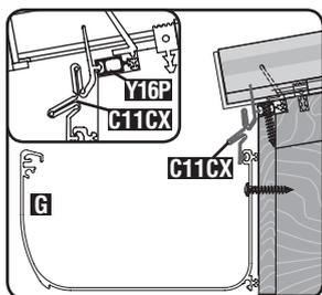
8. Positionnez la gouttière en alu G contre la planche de gouttière et étanchez les obturateurs avec du silicone. Fixez le joint C11CX entre la gouttière et le profilé Y16P.
