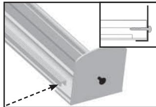
3. Découpez 25 mm du joint coex en bas du T16P. Vissez l'arrêt S16.3/ S32.3 avec vis RVS à l'extrémité du T16P.
